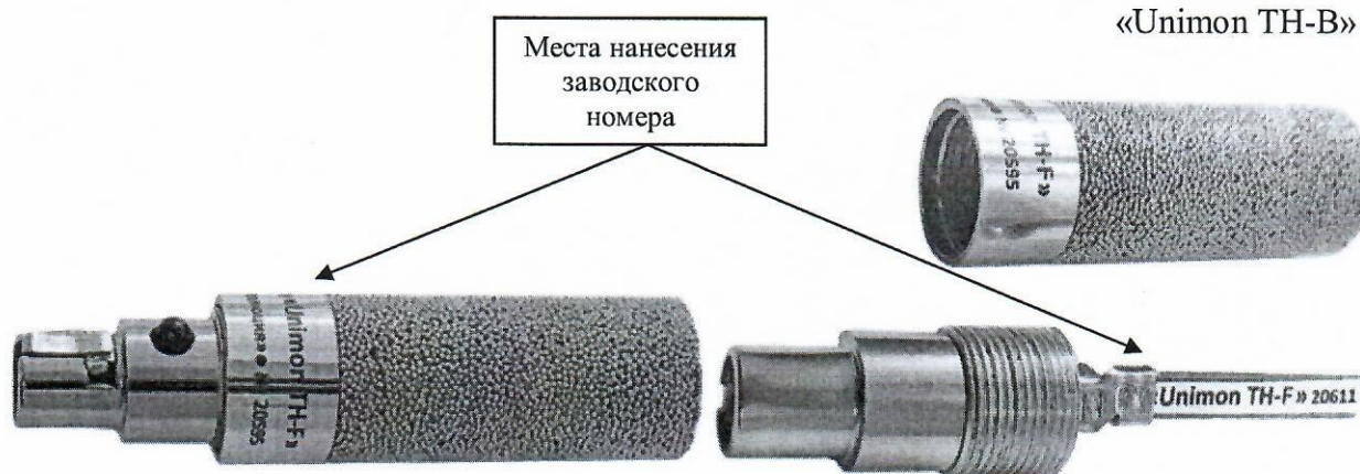
Рисунок 2 – Общий вид датчиков исполнения «Unimon TH-B»
